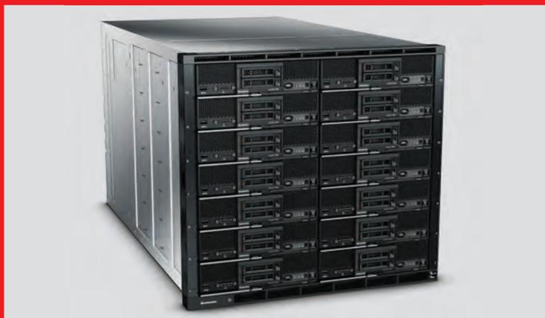
В настоящее время компания Lenovo разрабатывает и внедряет новые модули для созданной компанией IBM нового поколения блейд-систем под названием Flex System. Структура Flex System состоит из тех же компонентов, что и классическая блейд-система.
